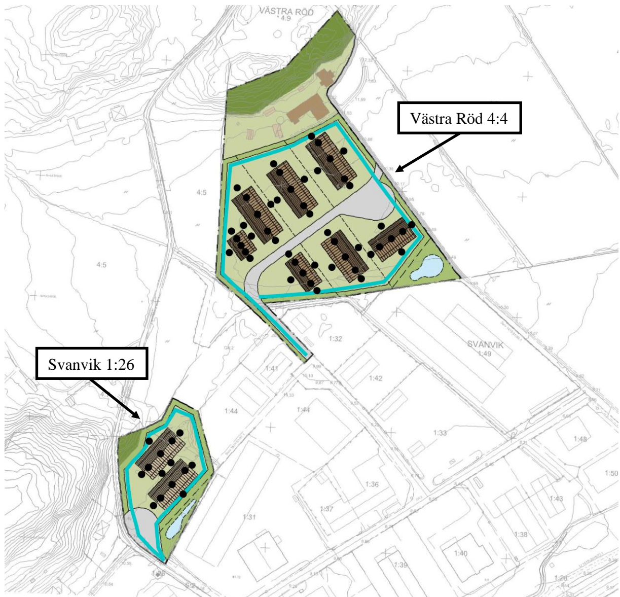
Figur 2: Illustrationsskiss av de planerade verksamheterna på fastigheterna Svanvik 1:26 och Västra Röd 4:4 tillsammans med modellerade ljudkällor (svarta punkter) och körande transporter (turkosa linjer).
